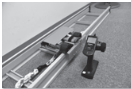
写真1 ケーブルラック配線用延線ロープ布設装置 (出典:「電気と工事」2017年11月号 「最新テクノロジーで行う電気工事」)
