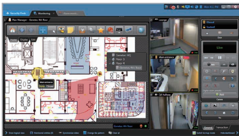
図 10 VMS による統合運用監視画面
