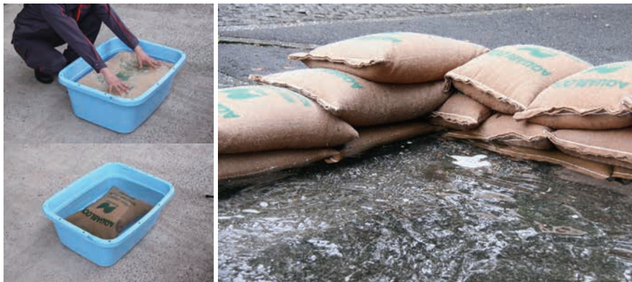
図5 収納性の高い水で膨らむ土のう
