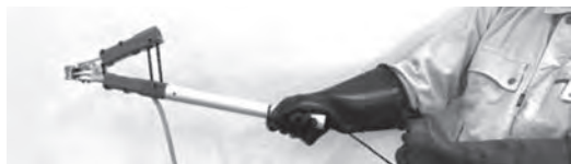
ロープを戻すとクリップが閉じる
