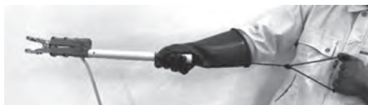
ロープを引くとクリップが開く
