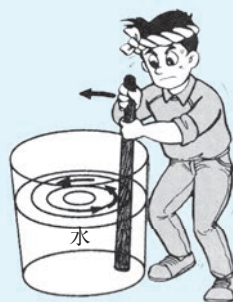
図11 粘性ポンプの原理 1)
