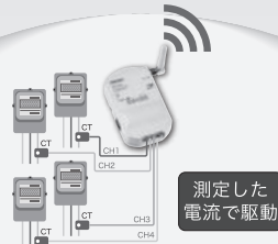
エネルギーハーベスト型 電流(交流)センサノード
