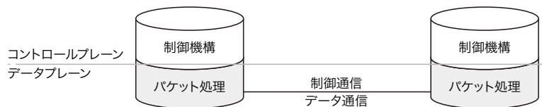
たとえば、IPプロトコルを利用してパケットの転送を行うルータは、コントロールプレーンとデータプレーンが同居したシステムです。各ルータは、ルーティングプロトコルなどを利用して各自が適切な経路を計算し、その計算結果とともにパケットの転送を行います。ルータ内に、経路を計算するためのコントロールプレーンと、パケットを転送するためのデータプレーンの両方が存在しています。
