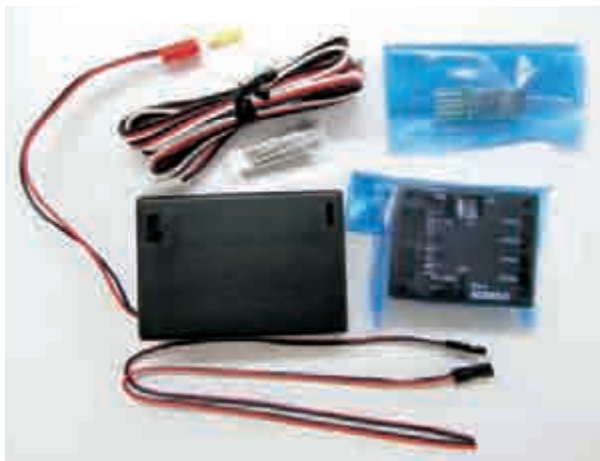
KCB-2のセット内容。黒い大きな箱は専用電池ボックスで、単三電池が3本入る。これはPCとの通信に使用するシリアルUSBアダプター2付きで6300円。ボードのみなら4200円で販売。
