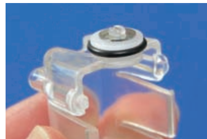
写真7 モーターホルダーにホイールをセット
