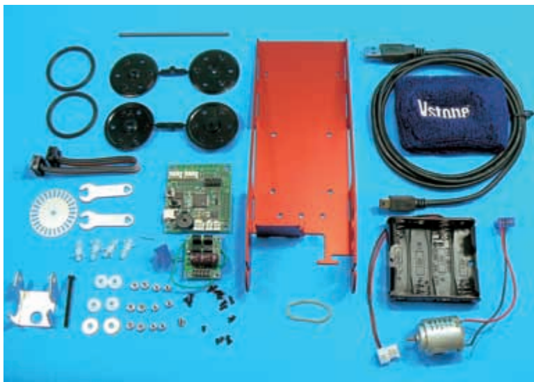
キットの主な部品。基板類は完成済みなのでハンダ付けは不要。小型のスパナが付属する。
