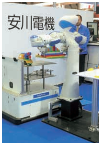
写真3 組立て終わったブロックを自動搬送車 RoboPorter に載せる MOTOMAN-SDA5D。
