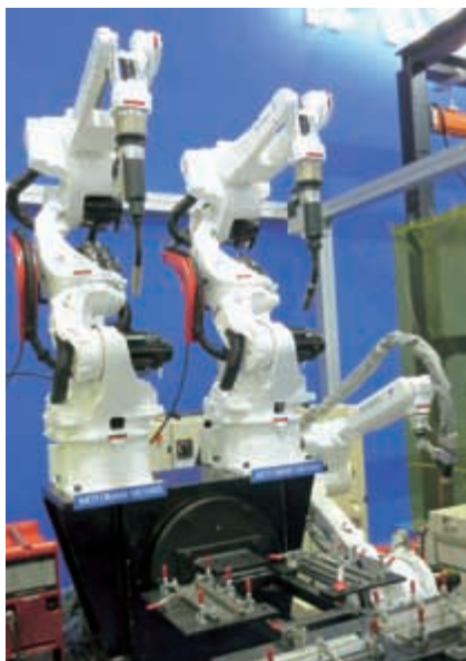
写真2 世界初の7軸アーク溶接ロボット (VA1400)。この他、難易度の高い溶接やゼロスパッタ溶接が可能な新製品も続々、発表。
