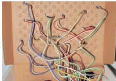
写真3 部品が入っていた箱が、そのまま「はこびか」となる。箱の中に基板と電池を入れて、ふたに用意されている穴へLEDを差し込むのだ。
