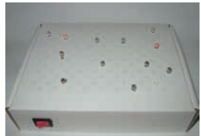
写真4 ふたを閉じて、スイッチを入れれば、ふたからのぞく12個のLEDの点滅が始まる。箱の代わりにオリジナルのボディを用意してもいい。
