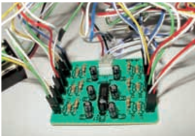
写真2 基板は完成されたものが付属する。そこに、LEDの点滅速度を変えるための抵抗を差し込む。
