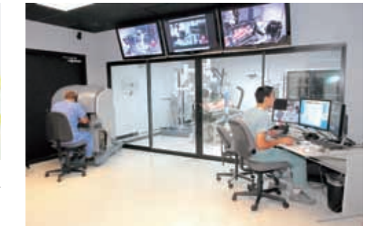
写真3 手術ロボットのパイオニア、「ダヴィンチ」。医師はボックス型のコンソールの中の患部の鮮明な3D画像を見ながら、左右のハンドルを手で操作し、手術室内のロボットアームに動きを伝える。アームは内視鏡1本、手術用に3本ある(©SRIインターナショナル)。
