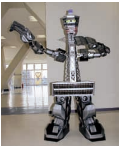
身長170cm、体重30kgの大型二足歩行ロボット。26自由度で、得意技は「ツッコミ」。
