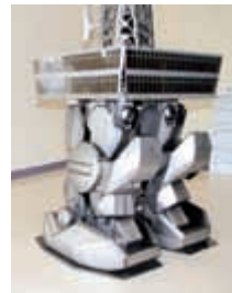
頭部の展望台が上下に可動し、目がLEDで光る。首軸と合わせて多彩な動きで、感情を表現する。
