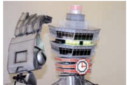
頭部の展望台が上下に可動し、目がLEDで光る。首軸と合わせて多彩な動きで、感情を表現する。
