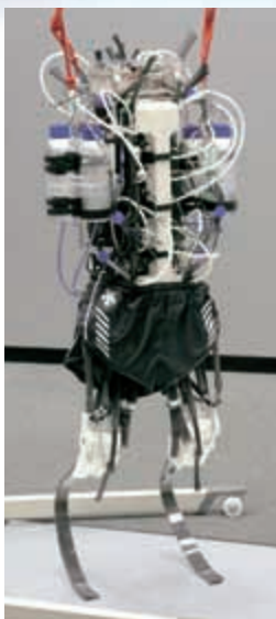
写真1 筋骨格型アスリートロボット。下腿は義足ランナーが付けるブレードを使っている(東京大学国吉康夫・原田達也研究室)。
