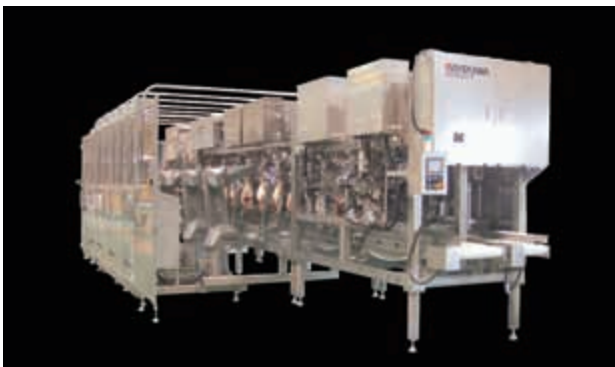
ハムダス Rの全体像。約12m半の長さの機械の中を豚もも肉が通されていく間に、右脚左脚の判別と骨に沿ったカット、骨からの肉のはがしをすべて自動で行う。1時間当たり500本の豚もも肉を加工できる(画像提供:前川電気)。
