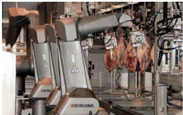
吊り下げられたもも肉に、先端にカッターが取り付けられた3本のマニピュレータが切れ目を入れていく。豚肉の複雑な骨の形に沿うことができるように6軸マニピュレータが使われている(画像提供:前川電気)。
