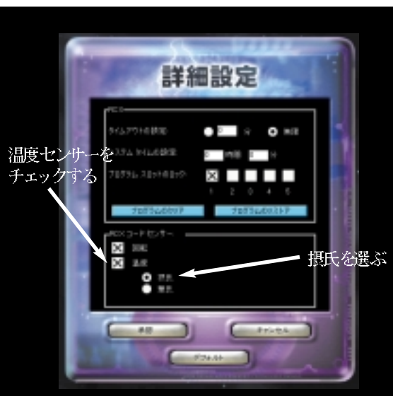
写真2 RCX CODE2で温度センサーを利用可能にする
