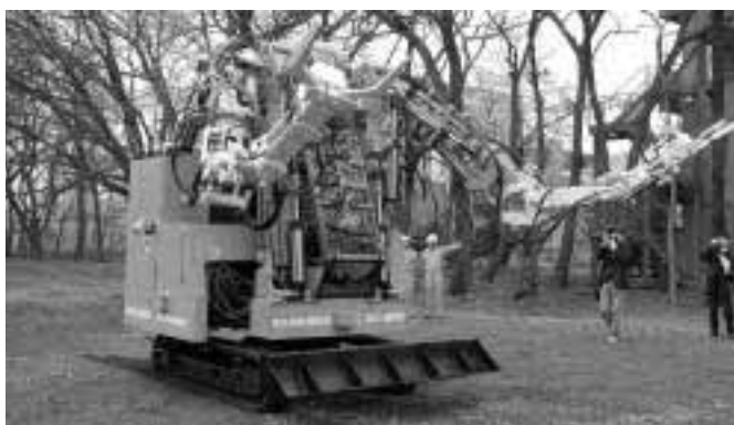
Tナンバー52・援竜は全高3.45m、全幅2.4m、重量5t。デザインにはロボガレージが関わっている。中央の黒い部分が人の搭乗スペース。カラーリングは消防側の要求らしい。
