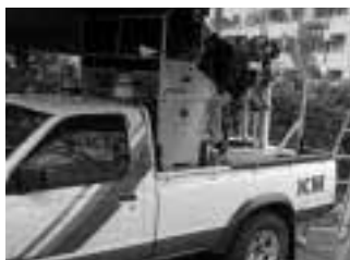
操縦装置はバンの荷台に接地できるコンパクトさ。実際にはトレーラ内などに入るだろうが、回線さえ確保できればどれほど離れていても操作可能だという。
