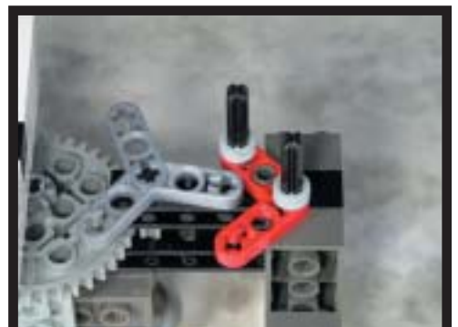
写真9 テンプを外した様子
