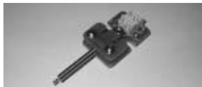
ロボデザイナー「RDS-X01:Platform」に含まれるタッチセンサ。
