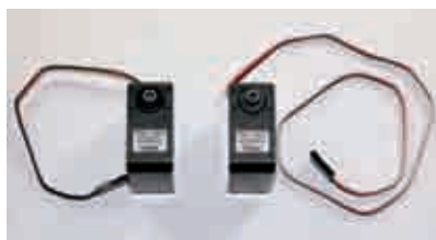
写真 2 サーボモーターには、ガイストンの「VS-S092J」を採用。トップケースとボトムケースにブラケット固定用ネジ穴が 6 個ずつ用意されている。ケーブル長は、400mm と 150mm の 2 種類がある。
