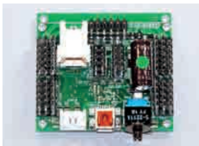
写真 3 コントロールボードとして、「VS-RC003HV」を採用。30ch のサーボ出力を搭載し、ネイティブ USB 対応。音声出力機能や IXBUS 準拠の拡張ポートも備える高機能ボードである。
