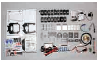
写真 1 Robovie-X の構成パーツ一式。この種の二足歩行ロボットキットとしては、パーツの数はやや少なめである。
