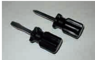
写真3 柄の短い、スタビドライバー。握ると先端に指が届くほどなので、ネジと合わせやすい。
