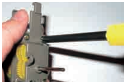
写真2 ネジに対して、まっすぐにドライバーの先端を使う。軽く押しつけるようにして回すのが、基本的な使い方だ。
