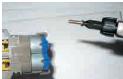
写真1 良いドライバーは、適合するネジと吸いつくようにぴったりとはまる。そのままネジ穴に持って行けるほどだ。
