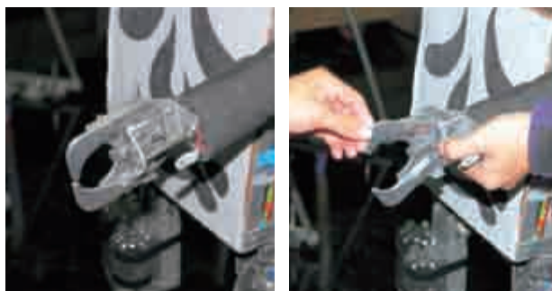
エアシリンダーが出て、手がロックしている状態。爪が開く力をガッチリ押さえられているのがわかる。
