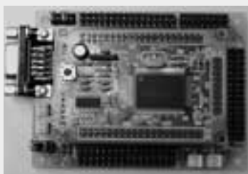
左にRS-232C端子、左上にジャンパ。中央基板が小型ベースボード。
