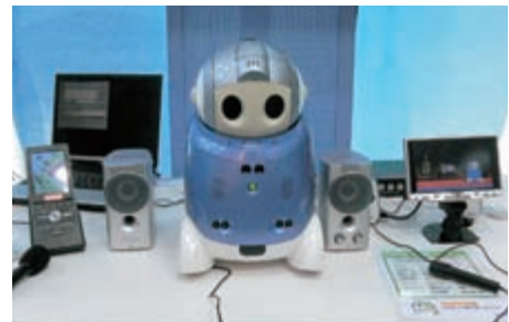
NECブースでは、「PaPeRo」を用いた「ネットワーク型ロボットエージェント(CG PaPeRo)」のデモが行われた。“本体”のPaPeRoがカーナビやPDAの中へ移動、“本体”の持つ情報やキャラクターを引き継いだCG PaPeRoを介して、端末への入出力を行うことができる。
