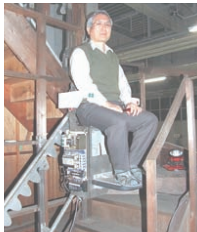
写真3 昇降機に乗る橋野氏。歯は下向きで安全性が高まったが、動作性能がダウンした。
