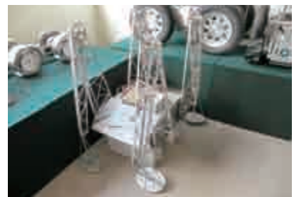
写真 3 KUMO-1。TITAN シリーズのルーツ。ザトウグモを模して作ったが、エネルギー損失が大きく、ゆっくりしか歩けなかった。設計原理 GDA を思いつききっかけとなった。1976 年。
