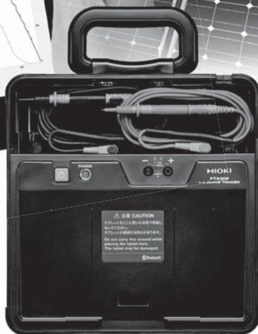
測定結果は無線送信でタブレットに表示、IVカーブ曲線を精細に表示、確認
