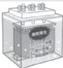
**【絶縁油中ガス分析】** 油入電気機器の内部で何らかの異常が発生すると、異常の様相ごとに特異的ガスが発生。絶縁油を採取し、油中溶存ガスを抽出・分析して運転中の油入電気機器の内部異常を早期に検知する技術です。
