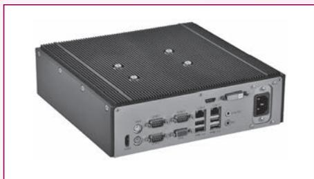
写真4 Zone 2 防爆シンクライアント「BTC01」背面
