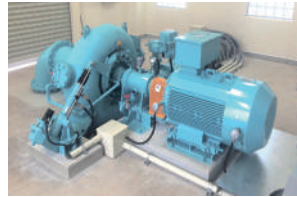
写真1 400V級/フランシス水車 幅広い流量・落差で適用
