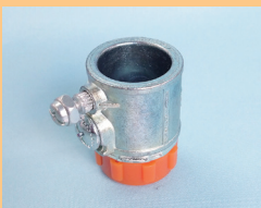
▲No.42 ねじなしボックスコネクタ (E19) (絶縁ブッシング、ロックナット、接地 端子付き)
