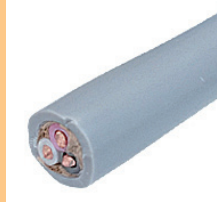
▲No.17 600V ビニル絶縁ビニルシースケーブル 丸形 2.0mm 3 心
