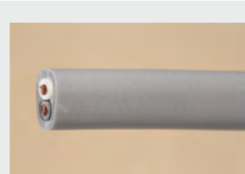
▲No.07 600V ビニル絶縁ビニルシースケーブル 平形 1.6mm 2心
