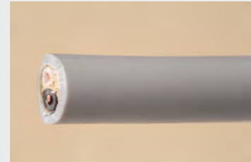
▲No.10 600V ビニル絶縁ビニルシースケーブル 丸形 1.6mm 2心
