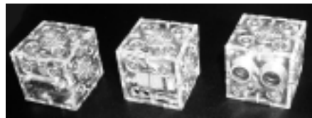
《写真4》付属する3つのブロック。左からリレーブロック、カーネルブロック、超音波ブロック
