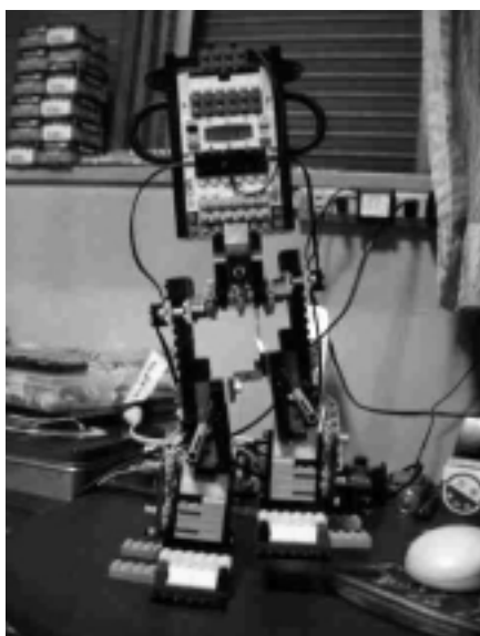
写真1 LEGO MINDSTORMS 2足ロボット
