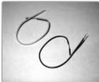
電池ボックス配線用のビニールコードも、もちろんその両端のビニールはむいてある。
