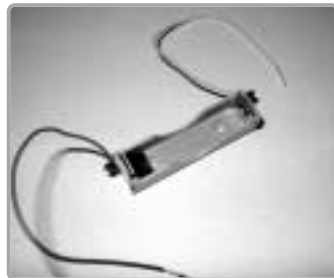
電池ボックスの組み立て方は、ロボクラフトシリーズで共通。キットによって、単3電池用と単4電池用がある。
