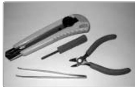
ロボクラフトシリーズの組み立てに必要な道具は、カッターナイフとピンセット、それにニッパーだけ。写真中央のプラスチックドライバーはキットに同梱されている。
