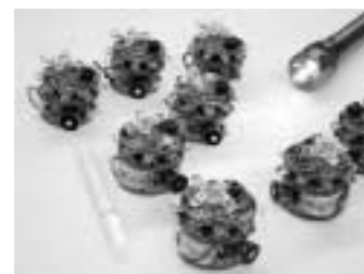
写真2 小型自律移動ロボット(MARS) 昆虫レベルの大きさで、互いの位置関係から自ら判断し、群れや 円形や三角形等のパターンを形成することができる。
