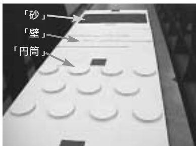
障害物走破用競技グラウンド(300×900mm) 障害物は「円筒」「壁」「砂」の3種類
