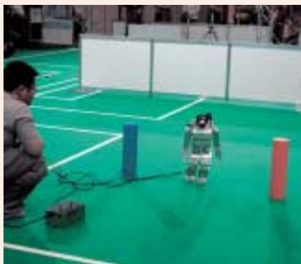
大阪大学Senchans2004は昨年に続いての参加。HOAP-2をベースにした機体。スラローム状に歩行する障害物回避の様子。昨年は歩くこともままならなかったが今年はかなり改良されてきた。ただしバッテリーなど外部にケーブルが出ているため大幅に減点される。
