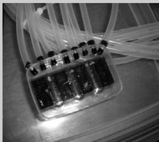
写真2 フレグラの匂い提示部。腕に装着できるようにしたことから、装置の軽量化・小型化などが可能になった。
