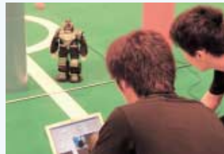
スラローム歩行の調整中。全方位カメラ搭載の「VisiON」は確実に課題をこなしていく。
