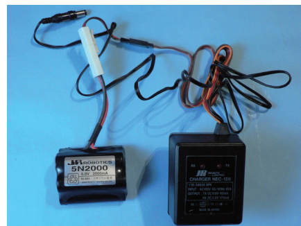
写真2 ニッケル水素バッテリー(左)とACアダプター(右)。バッテリーは2000mAhと大容量だ。ACアダプターでフル充電するには、約10時間かかる。
