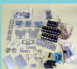
写真1 KHR-2HVの部品一覧。板金パーツがぐっと減っているのがわかる。この時点ではどこに使うのか謎のパーツも。
