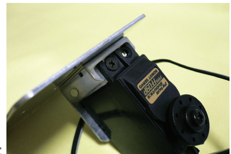
写真3 ひざサーボの固定
