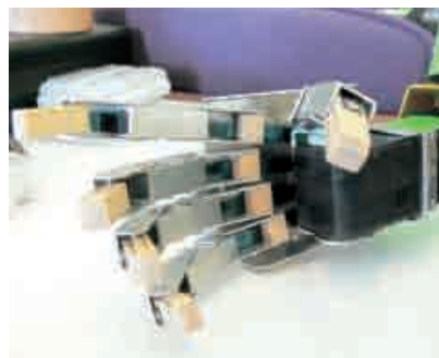
「クロムキッド」の手を内側から撮影。指の内側に見える黒いものが指を動かす銅板だ。
