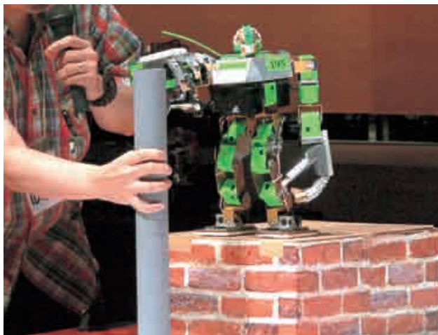
「クロムキッド」が行った「蛇口を開ける」デモ。人間と同じように、握る→開ける→つかみ直す→開けるという流れを再現していた。
