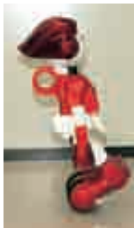
4輪の状態から2輪の状態に変形する様子。
