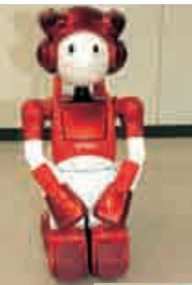
「EMIEW 2」の4輪移動の状態。脚を曲げて膝をついた状態となる。車輪は両足の2輪と、両膝についている車輪(受動的なもの)である。
