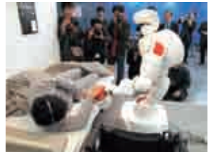
写真3 おばあちゃん(学生)が差し伸べて欲しいところに、TWENDY-ONE の手が移動し、支えてくれる。
