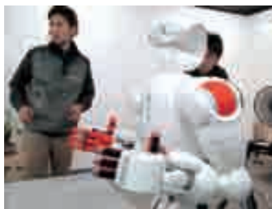
写真2 手の甲、前腕、肘は柔軟材で被覆されている。
