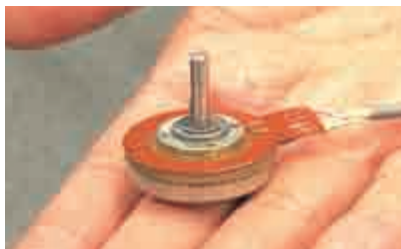
写真17 マニピュレータに用いている超音波モータ
