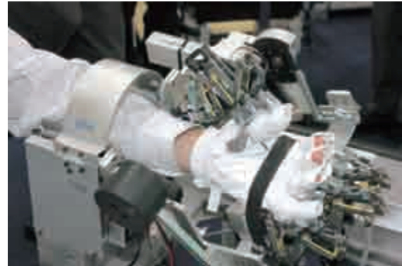
「イメージトレーニング機能付き手指・上肢リハビリ支援ロボット」。モニタに表示されているのはトレーニングの課題。モニタに表示されるトレーニング内容に従って、健常な側の手を動かすことで麻痺のある手のリハビリを行う。リハビリロボットと指の関節は磁石で付いている。
