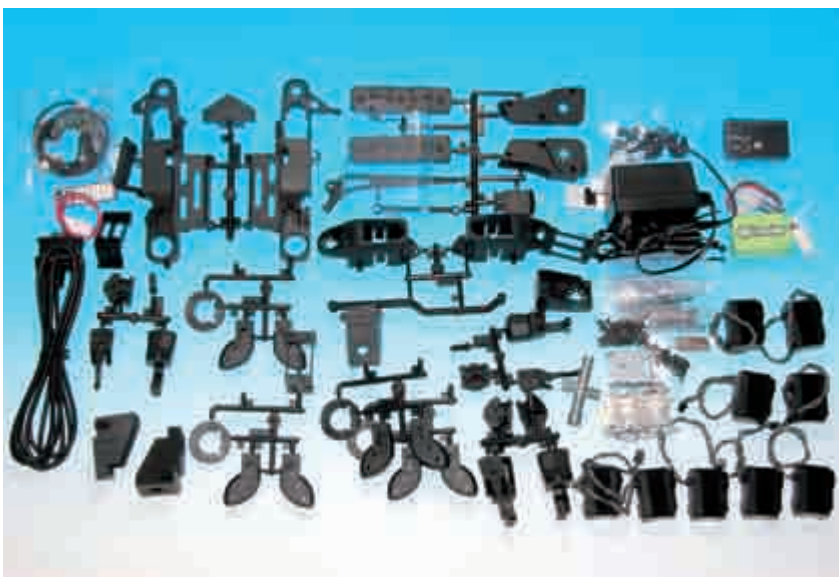
G-Dogの構成パーツ一式。二足歩行ロボットキットに比べると、パーツの数は少なめである。
