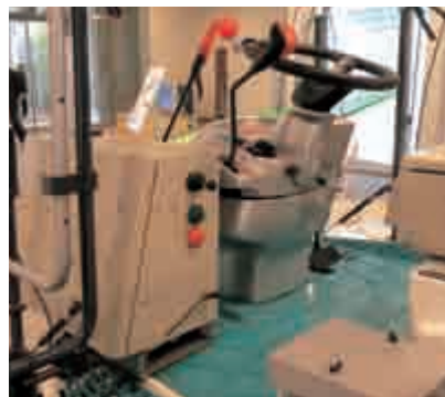
写真3 ステアリングの左の「くの字状」ロッドがHST操作レバー。
